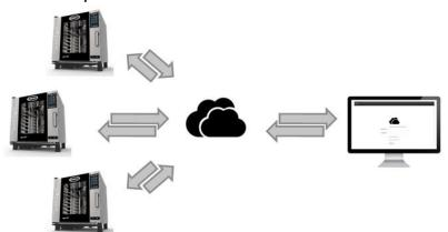
Печь получает и отправляет все данные на облачный сервер Unox, расположенный в Италии, используя исходящий HTTP-трафик (TCP) с 80ю-портоми облачного сервера. 80 портов облачного сервера – это стандартный сбор, используемым каждым устройством, иногда он может быть заблокирован, чтобы предотвратить просмотр в интернет браузере. В этом случае после проверки печь даст сигнал
