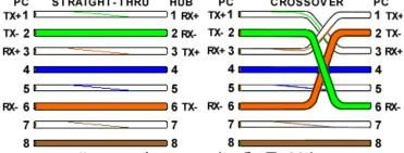
представляет собой подключенный с двух сторон по одной спецификации (либо Т568A или Т568B). Поскольку оба конца обжаты одинаково, такой соединительный кабель называют «сквозным» кабелем.
